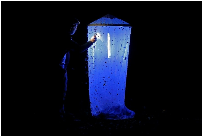
Bild 1: Großer Leuchtturm am Ringkogel, 2 Leuchtröhren à 20 Watt.
